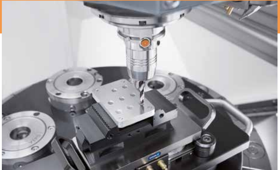
Schlüsselbaustein: Der smarte Werkzeughalter Itendo 2 unterstützt die Digitalisierung von Werkzeugmaschinen. Bild: Schunk
