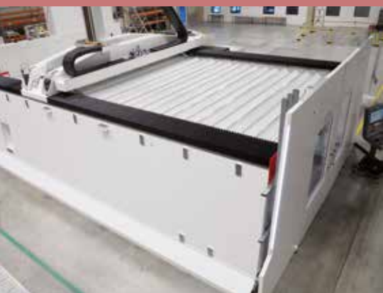
Noch steht die Maschine in Neuhausen. In Oberframmern wird Schröter komplette Fahrzeugmodelle in einer Aufspannung von fünf Seiten bearbeiten können.
