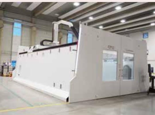
Die 5-Achs-Portalfräsmaschine FZP32 ist dank ihres thermosymmetrischen Aufbaus sehr genau. Sie bietet eine hohe Produktivität und Verfügbarkeit.
