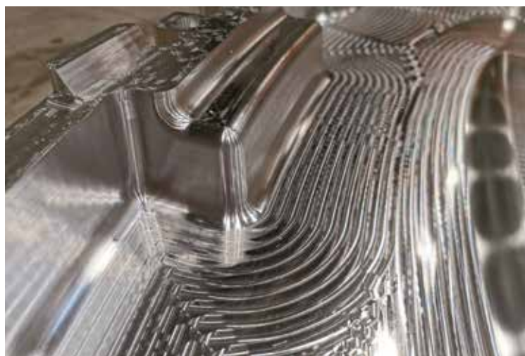
Aus massiven Aluminiumblock gefrästes Formteil bei Pentas
