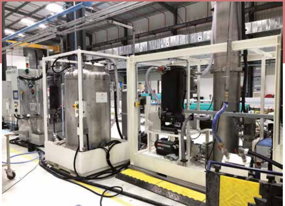
Die Vakuum-Entgasungsstation T-EVAC – hier in der Montage – bietet Anwendern in Vakuuminfusion, Nasspressen, Resin Transfer Moulding und Pultrusion die Möglichkeit, ihre Formgebungs- und Applikationsprozesse und ihre Produktqualität zu verbessern.
