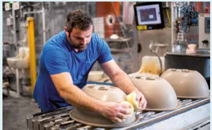
Geübte Spezialisten bearbeiten die Produkte nach dem Gießen, aber vor dem Brennen – der sogenannte Grünputz. Bild: Villeroy & Boch
