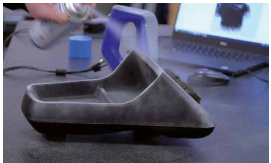
Die Mittelkonsole wird für den Scan vorbereitet: Das AESUB Scanningspray wird gleichmäßig auf die Konsole gesprüht. Innerhalb weniger Sekunden entsteht eine hauchdünne weiße Schicht von ca. 8 - 15 µm. Die Schicht sublimiert nach einigen Stunden, so dass weder die Konsole noch die Sprühumgebung gereinigt werden müssen.
