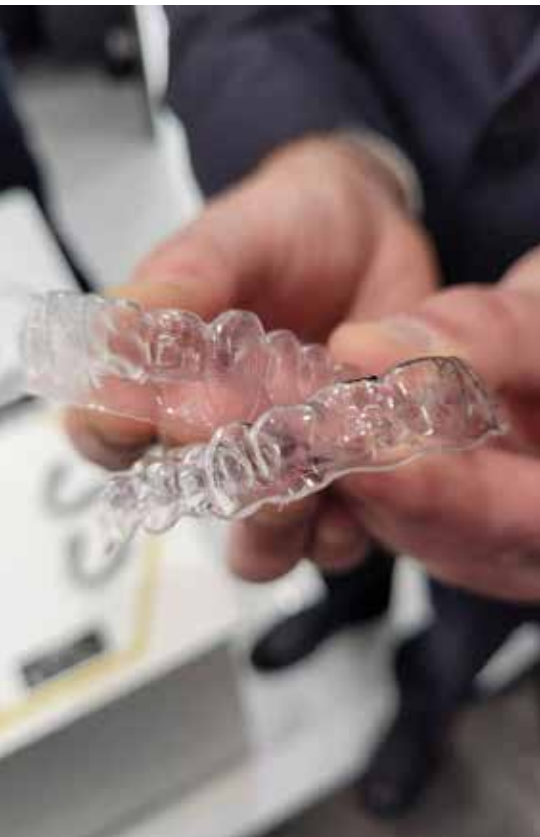
Bei der Erstellung von Zahnschienen ist der Lumia 3D-Drucker fast 20mal so schnell wie herkömmliche SLA-3D-Drucker.
