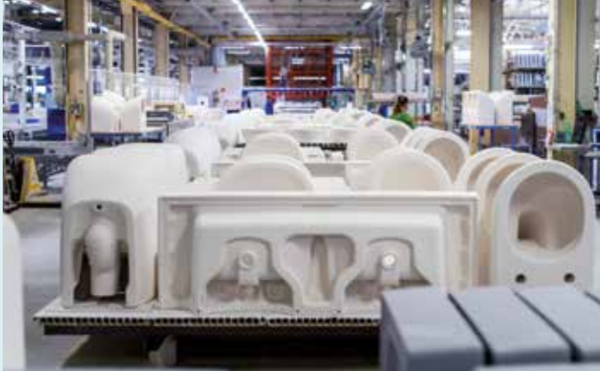
Täglich werden 2000 Teile in dem großen Ofen, der in der Zukunft von Gas auf Wasserstoff umgerüstet werden soll, gebrannt. Bild: Villeroy & Boch
