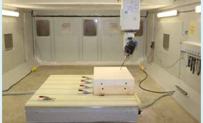
Mit der fünfachsigen Simultan-Fräsmaschine können die Bohrungen für die Drainage in beliebigen Positionen ausgeführt werden. Bild: Dieckmann
