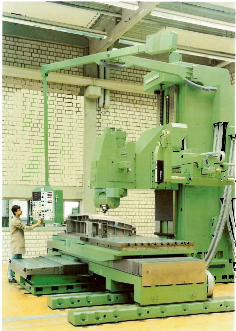
VH4/15-NC/FIDIA mit Schwindmaßkopiereinrichtung
