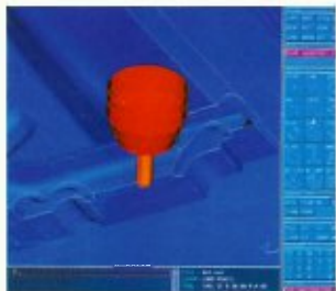
Automatisch berechnete Pencilbahnen beschleunigen die Nachbearbeitung von Restmaterialbereichen
