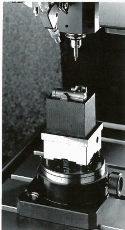
Schnell und sauber: Fräsen von Graphitelektroden Foto: Lang
